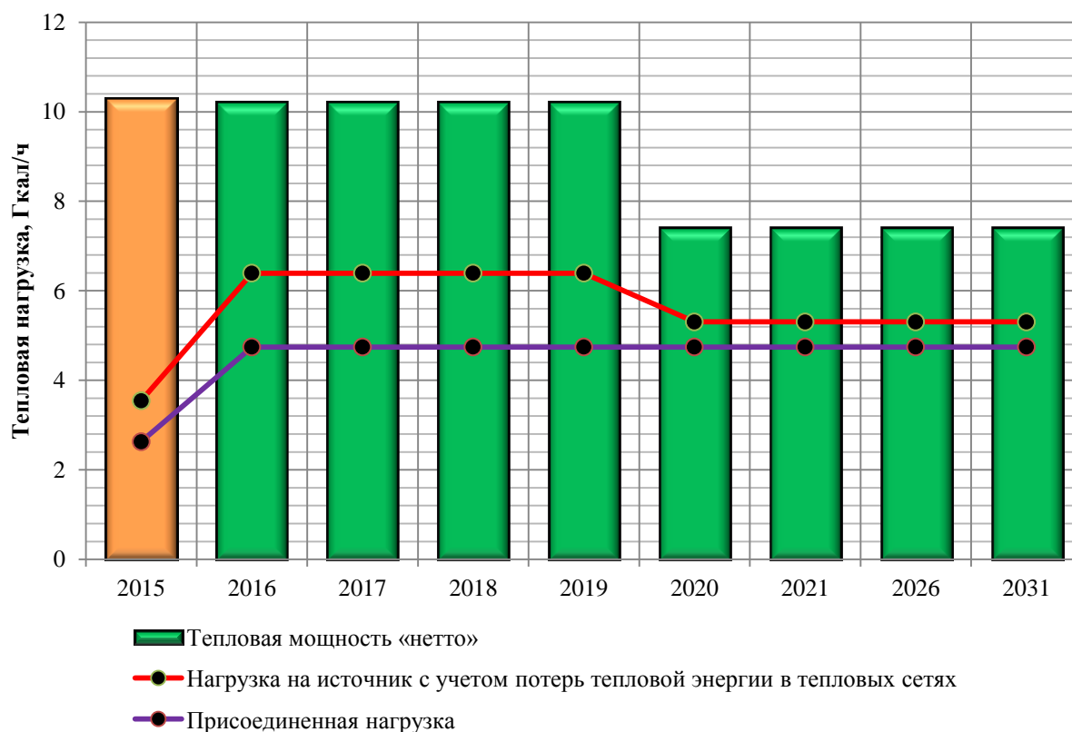
Рисунок 29 – Баланс тепловой мощности котельной Симферопольская, 98
