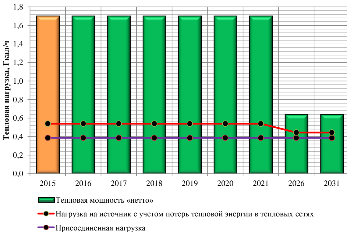
Рисунок 15 – Баланс тепловой мощности котельной по ул. Пушкина, 22
